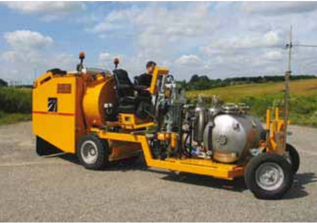
Çift komponentli boya uygulaması için, orta ölçekli yol çizgi makinesi. Havalı sistemle çalışan bu makineye nokta desenli çizgi donanımı eklenebiliyor.
